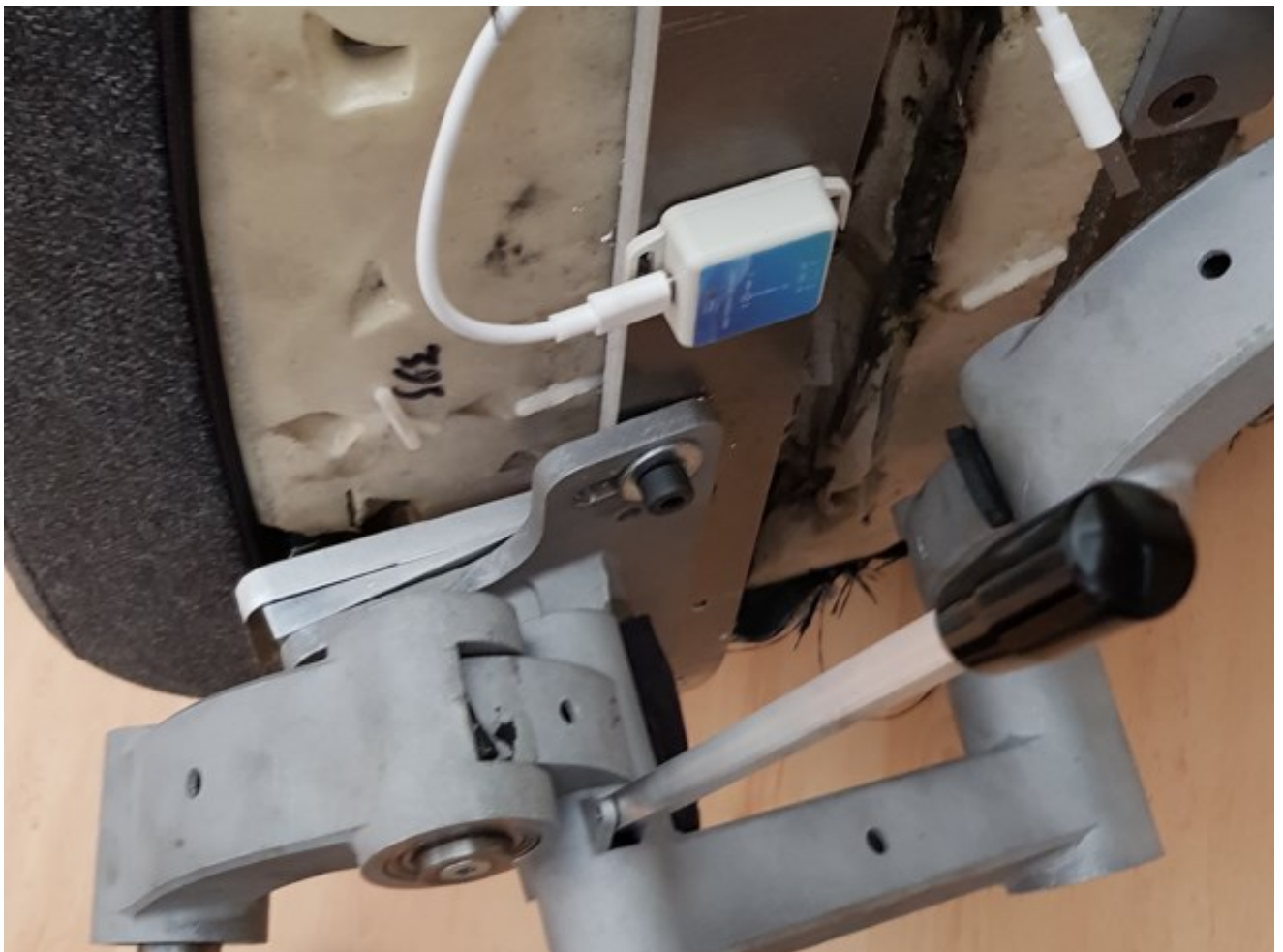
Bild 1: Anordnung des 9 Achs Sensors am Stuhl
